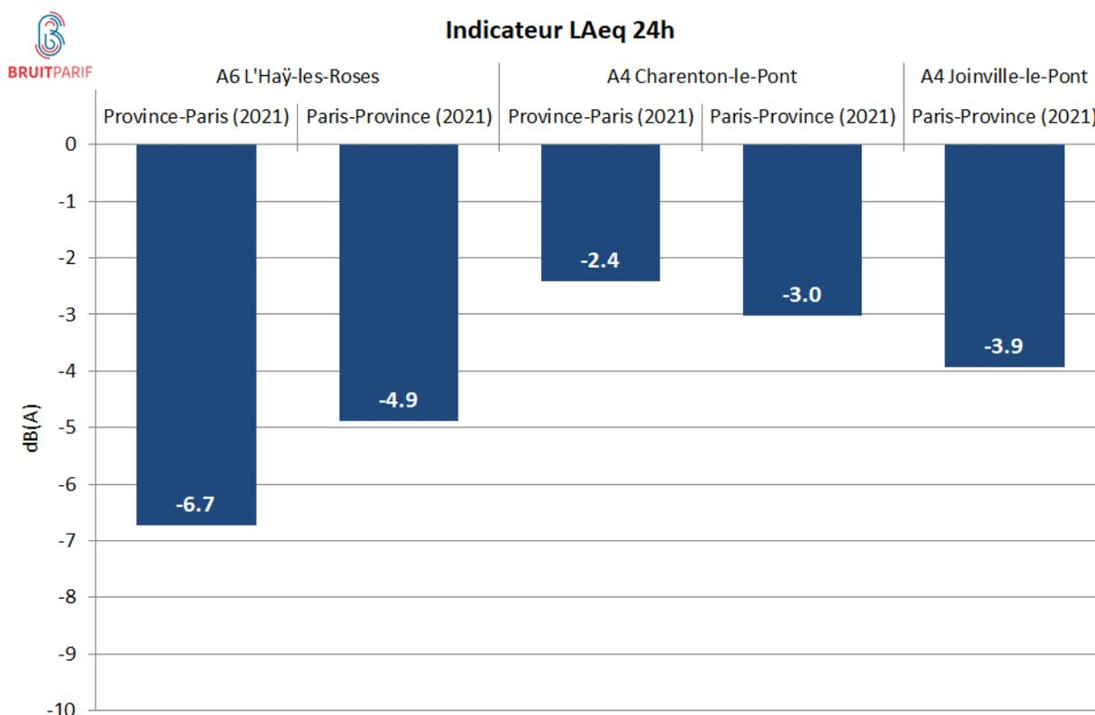
Figure 7 : Réduction moyenne des niveaux sonores LAeq 24h au cours de la seconde partie de l'année 2021 (après le 1<sup>er</sup> septembre) par rapport à la situation avant pose des revêtements (mi-2017), selon les sens de circulation (avec corrections liées aux variations des températures (A4 et A6) et des trafics (A4)).
